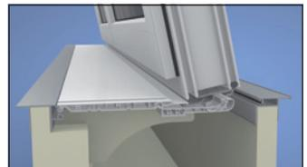
**4** Verbinden Sie den Blendrahmen mittels Statikprofil mit dem Kasten.
