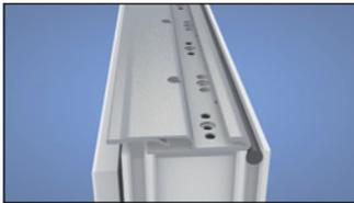
**2** Das Statikprofil mit den Raststücken auf den Blendrahmen aufsetzen und ca. alle 20 cm im Bereich der Raststücke verschrauben. Das Statikprofil ist 30 mm kürzer als die Blendrahmenbreite. Die Fuge zwischen Rolladenkasten und Blendrahmen ist entsprechend den anerkannten Regeln der Technik auszuführen.
