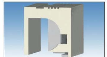
8 Verbinden Sie den oberen Teil der Statikkonsole durch die dafür vorgesehenen Bohrungen im Rollladenkasten mit dem Sturz. Unter Umständen die Bohrung durch den unteren Dämmkeil des Rolladenkastens ansetzen. Das Bohrloch anschließend fachgerecht verschließen.
