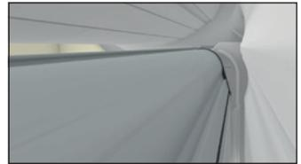
**3** Beim TNB Revision Innen entfernen Sie das Abrollprofil am Kastenboden. Beim TNB Revision Außen wird das Abrollprofil durch die Fliegengitterkassette ersetzt. Fädeln Sie das Fliegengitter von oben in die Fliegengitterführung ein und rasten Sie die Fliegengitterkassette an beiden Seiten in die Kopfstücke ein (Darstellung bei TNB RI).
